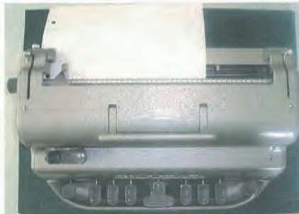
Mit so einer Punktschriftmaschine lassen sich Texte schreiben, die Blinde mit den Fingern ertasten können.
